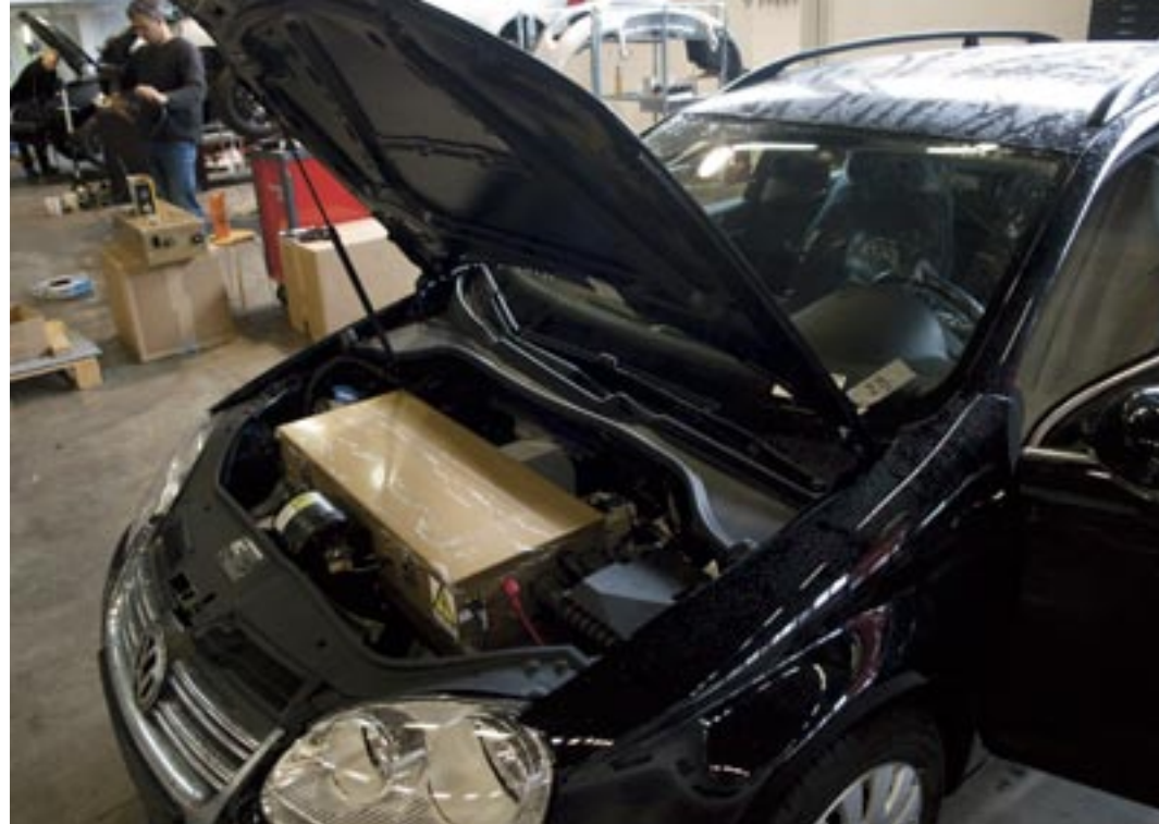
Bij ECE wordt de benzinemotor uit de auto gehaald en vervangen door een batterij
